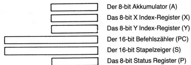
Abb. 1-5 Funktionselemente des Mikroprozessors 6502
