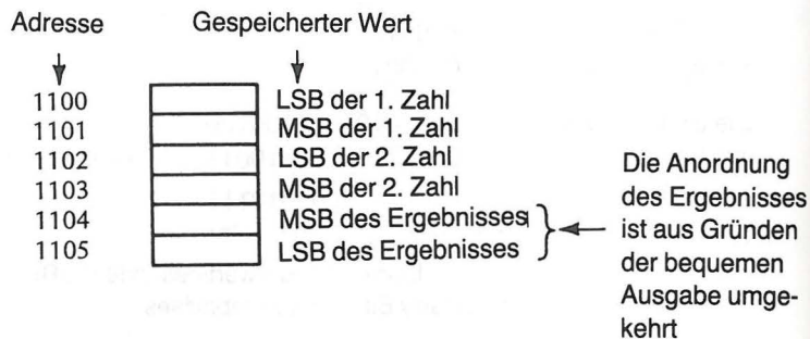
Abb. 9-2 Speicheranordnung für die Zwei-Byte Addition
